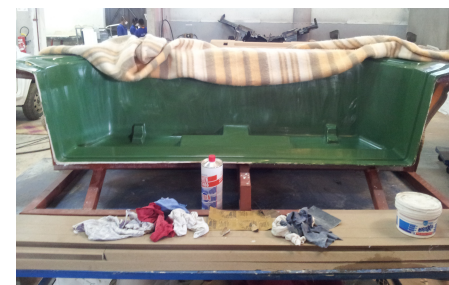
Moule réalisé à partir de la pièce en bois
