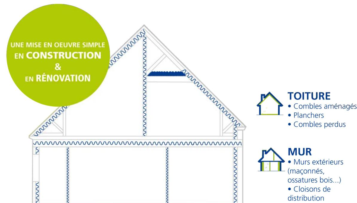
Quelle que soit la nature du projet – isoler de la toiture (combles aménagés, planchers, combles perdus) ou des murs (murs extérieurs maçonnés ou à ossature bois, cloisons de distribution) - l'étendue de la gamme Métisse® permet de répondre à chaque besoin : panneau, rouleau, flocons, baffle<sup>5</sup>...
